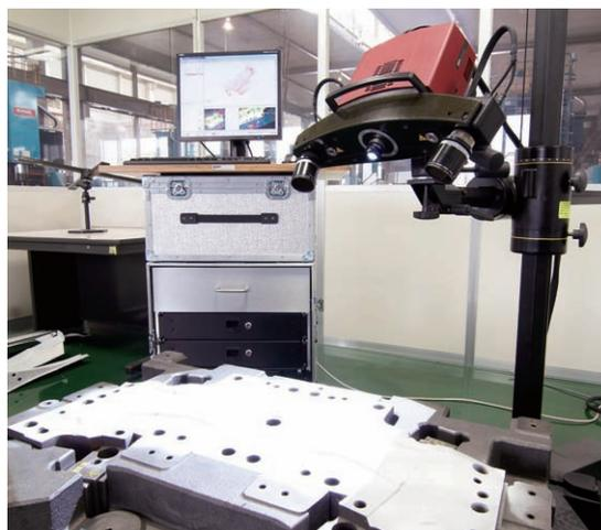
3次元測定器で金型精度、製品精度を計測
