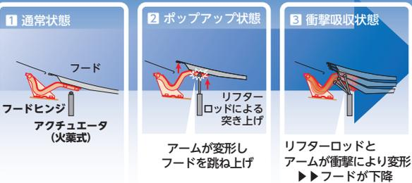
国内交通事故死者の35%は歩行者であり、その中でも頭部打撲を原因とするものが60%を占めています。自動車には歩行者保護の世界統一基準が定められ、各国での法規制化が進む中、「ポップアップフード」がトヨタ・新型クラウンハイブリッドに初搭載されました。これは、衝突を感知するとリフターが作動、フードヒンジ（エンジンフードの開閉時に蝶つがいの役割を果たす部品）のアーム部分を変形させ、エンジンフードを瞬間的に持ち上げることで、その下に空間をつくり、歩行者への衝撃を和らげる衝突安全性向上機能です。当社は、その機能で重要な部品となる「ポ
