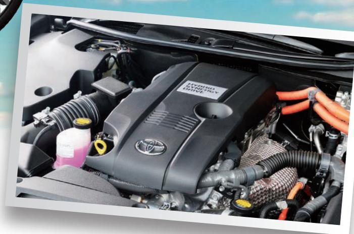
自動車エンジン上部に搭載されるエンジンカバーは、防音性能と意匠性向上の目的で、近年、ほとんどの車に搭載されています。環境配慮や燃費向上が求められる中で、更なる軽量化を図るため「発泡成形」という工法に着目し、製品開発に取り組んできました。材料開発と金型技術の深化により、微細な発泡層の形成と良好な意匠外観を確保することができるようになり、世界で初めて高耐熱ナイロン材での化学発泡成形の技術を確立し、製品化を達成しました。発泡成形は樹脂の内部に発泡層を形成することで、少ない樹脂量でも板厚の確保が可能で、従来品と同等の剛性を保ちながら、30%の軽量化ができます。本製品は、トヨタ・新型クラウンハイブリッドに採用され、その軽量化技術が認められたことで、2013年1月、トヨタ自動車より「クラウン・プロジェクト表彰（技術の部）」を受賞しました。
