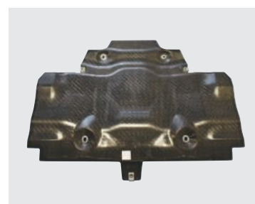
GFRP採用のマルチ材料の軽量アンダーカバー
