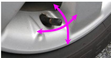
バルブとホイールのシール部からの空気もれは、写真のように、バルブを上下・左右に傾けながら確認してください。
