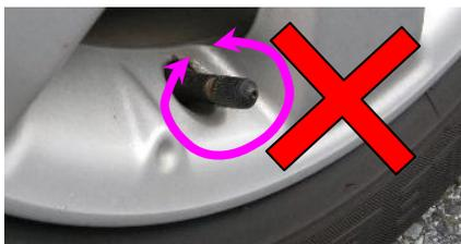
道具などを使ってキャップを過大な力で締めつけたり、写真のようにバルブを円周方向に回転させないでください。
