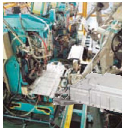
当社はプリウスやレクサス等のハイブリッド車のバッテリー(電池)を格納するケースを生産しています。バッテリー性能劣化を防止するための冷却構造や高圧電気回路の絶縁対策を考慮し、ケースの小型化・軽量化に取り組んでいます。
