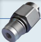
圧力異常時にシステムを保護する安全弁機能と、下流のスタックが正常に作動するための圧力調整機能を備えた**水素燃料用リリーフバルブ**。主要部材には耐水素脆性のあるアルミを採用、コンパクトで高機能ながら高い価格競争力も実現しました。
