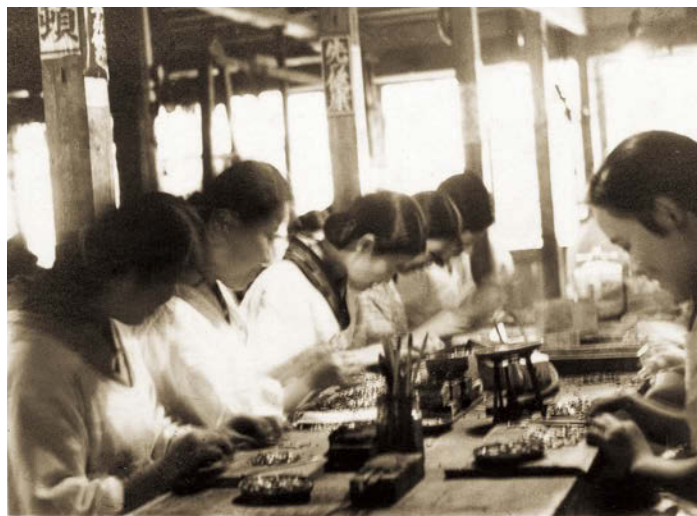
創業当時のころのバルブコアの製造風景。女子工員が手作業で作っていた
